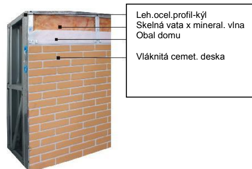
Vnější systém stěn
